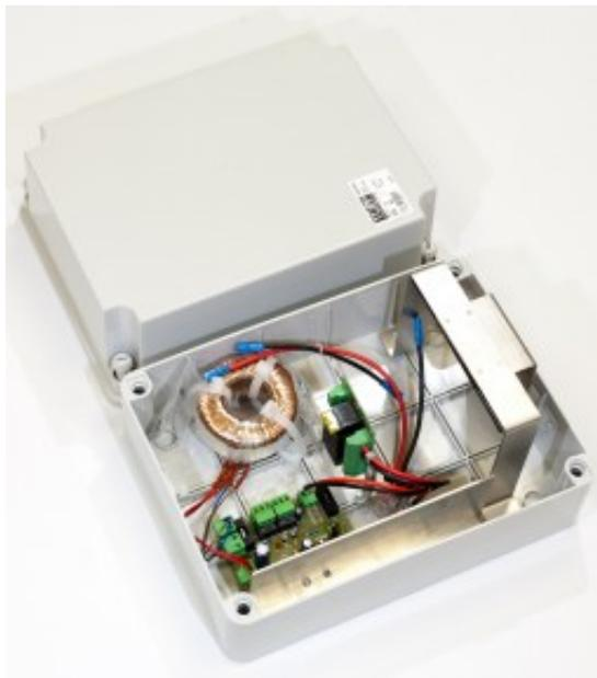
MEM/AL Модуль дымоудаления (расширения пожарной системы, 24В)
